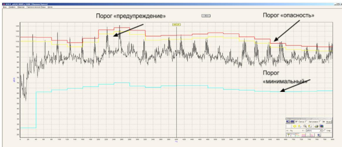
Рисунок 2 – Мониторинг уровня вибрации гармонических составляющих в спектре по пороговым значениям
