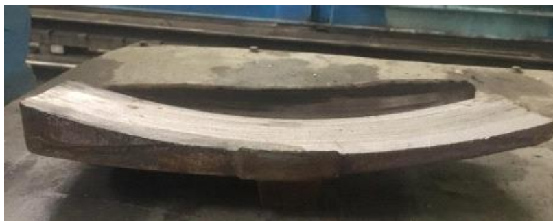
Рисунок 2 – Тормозная колодка с клиновидным износом
