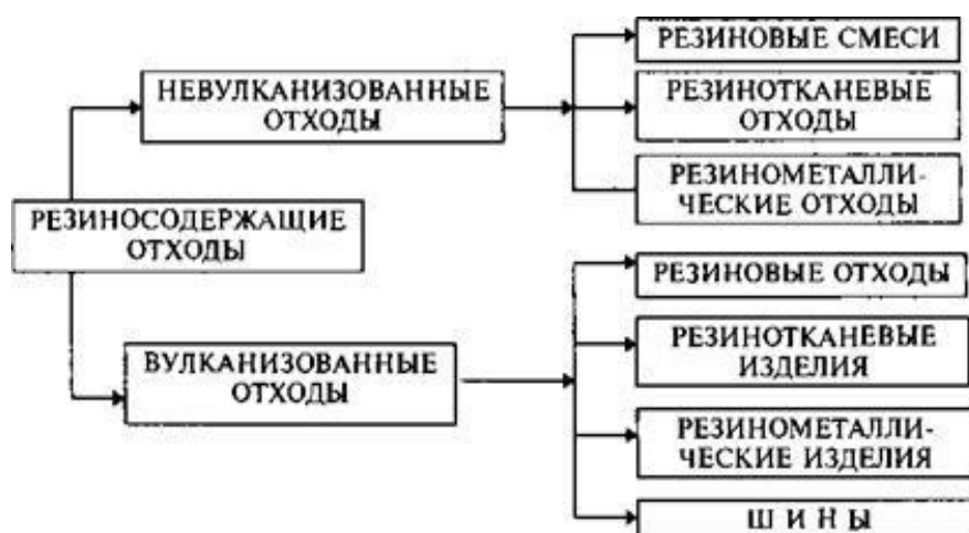
Рисунок 1 – Классификация резиносодержащих отходов
