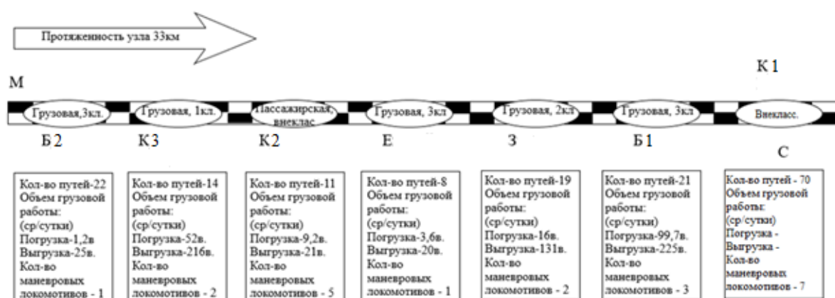
Рисунок 1 - Схема железнодорожного узла
